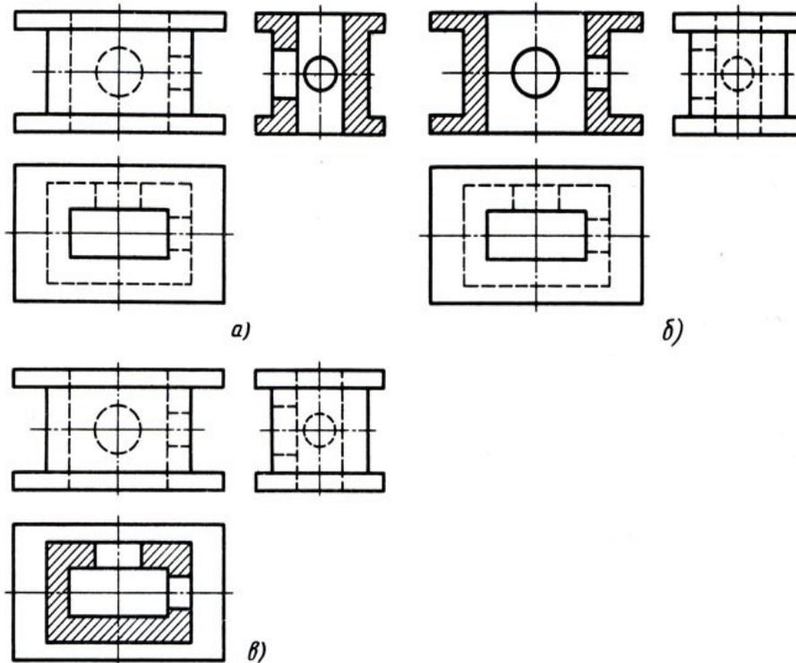
1. а) – простой горизонтальный разрез; б) - простой горизонтальный разрез; в) – простой вертикальный профильный разрез.
