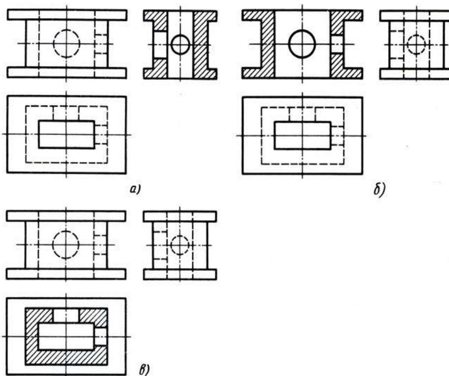
1. а) – простой вертикальный разрез; б) - простой вертикальный разрез; в) – простой горизонтальный разрез.
